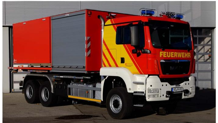
Als zweiter neuer Abrollbehälter wurde der "AB Sonderlöschmittel" in Dienst gestellt. Hierauf werden insgesamt 250 kg Metallbrandpulver, 220 kg Kohlendioxid und 220 kg normales Löschpulver in trag- bzw. fahrbaren Feuerlöschern verschiedener Größen und einer fest installierten Löschanlage mitgeführt. Damit ist die Feuerwehr Kempten auch für nicht alltägliche Brände, z.B. von Metallen oder in größeren Elektroanlagen, gut gerüstet.
